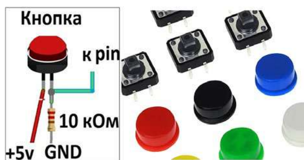
Рис. 1. Схема подключения тактовой кнопки к микроконтроллерной плате
